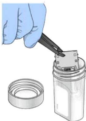
Рисунок 10. Извлечение проточной кюветы
