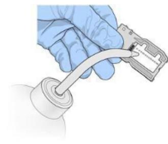
Рисунок 11. Промывка проточной кюветы
